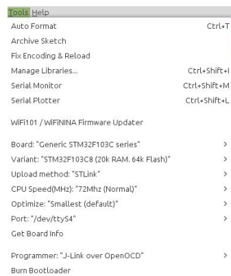
Figura 1: Opciones Arduino para STM32 con st-link
