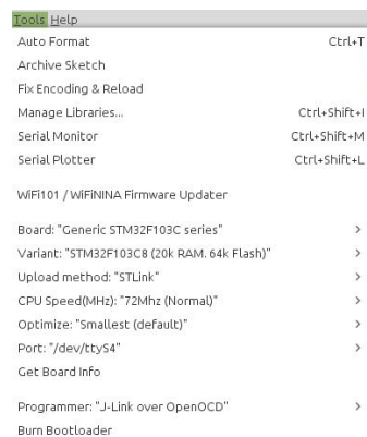
Figura 1: Opciones Arduino para STM32 con st-link
