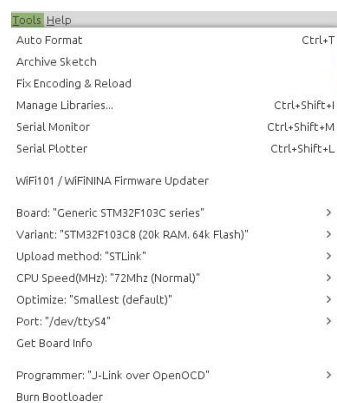
Figura 1: Opciones Arduino para STM32 con st-link
