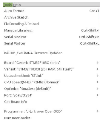
Figura 1: Opciones Arduino para STM32 con st-link
