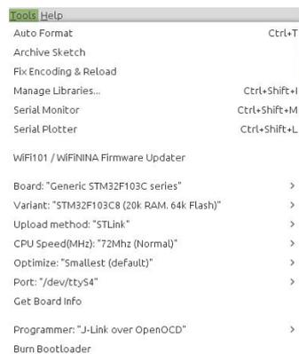
Figura 1: Opciones Arduino para STM32 con st-link
