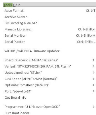
Figura 1: Opciones Arduino para STM32 con st-link
