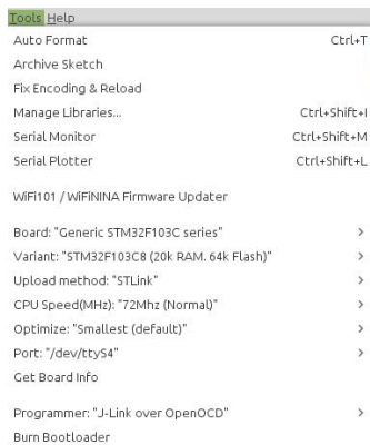
Figura 1: Opciones Arduino para STM32 con st-link
